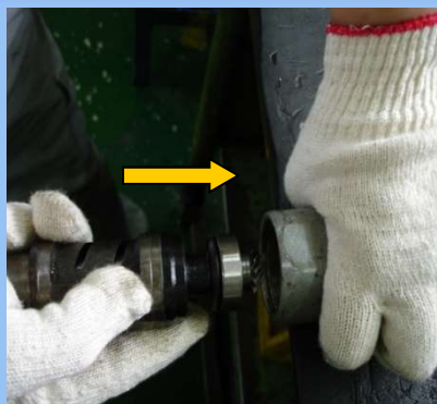
22) CASING에 MOTOR MODULE 조립
