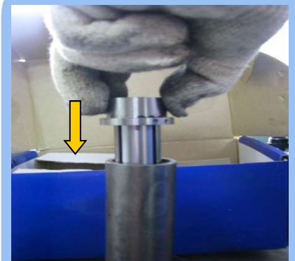
12) ROTOR와 REAR PLATE 간격조정 (0.02mm)
