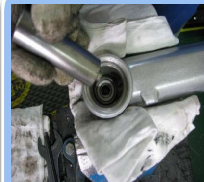
18) CASING에 BEARING(629ZZ) 조립
