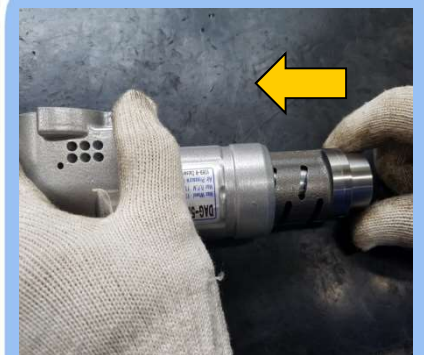
30) MOTOR MODULE 조립 -> 케이싱에 모터 삽입
