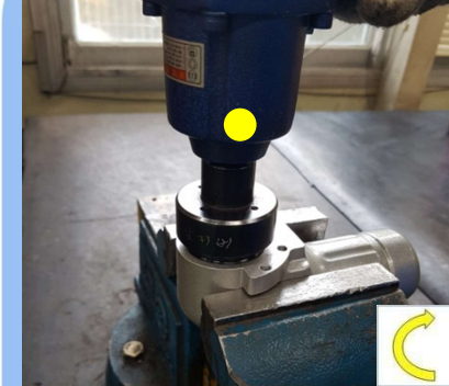
9) CASING FRONT COVER 분해 (IMPACT WRENCH 사용)
