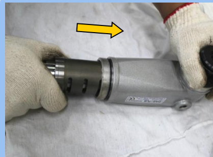
58) MOTOR ASSY를 CASING에 조립
