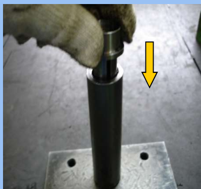
11) ROTOR, REAR PLATE 간격 조정
