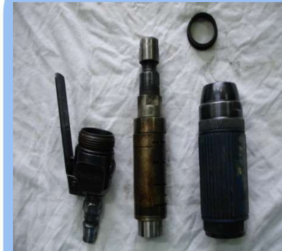
3) HANDLE BODY, MOTOR MODULE 분해 모습
