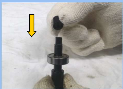
46) COLLECT CHUCK에 INNER SPACER 조립 (프레스)
