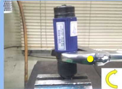
44) CASING과 HANDLE BODY ASSY 조립
