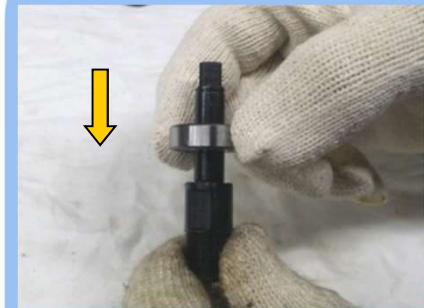
45) COLLECT CHUCK에 BEARING 조립 (프레스)
