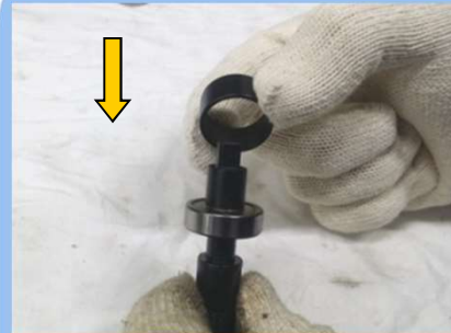
47) COLLECT CHUCK에 OUTER SPACER 조립
