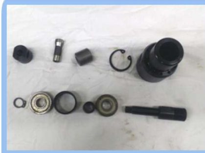
17) COLLECT CHUCK CASING 분해 모습
