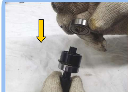
48) COLLECT CHUCK에 BEARING 조립 (프레스)
