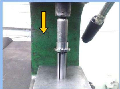
34) ROTOR와 REAR PLATE 조립
