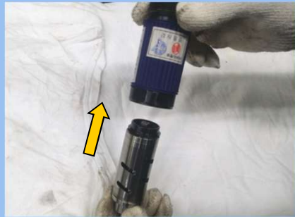
43) ROTOR ASSY와 CASING 조립
