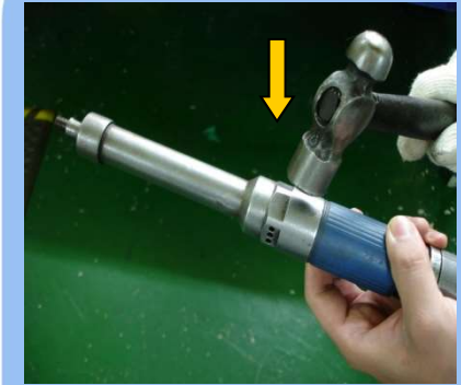
3) WHEEL SPINDLE CASING과 CASING 나사부 망치로 충격을 가한다.
